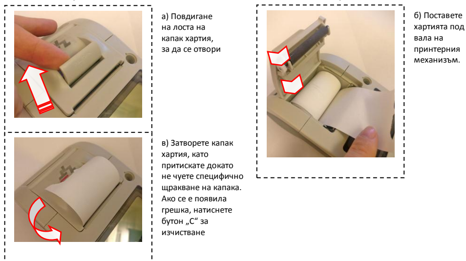
Фигура 4. Зареждане на термохартиена лента
